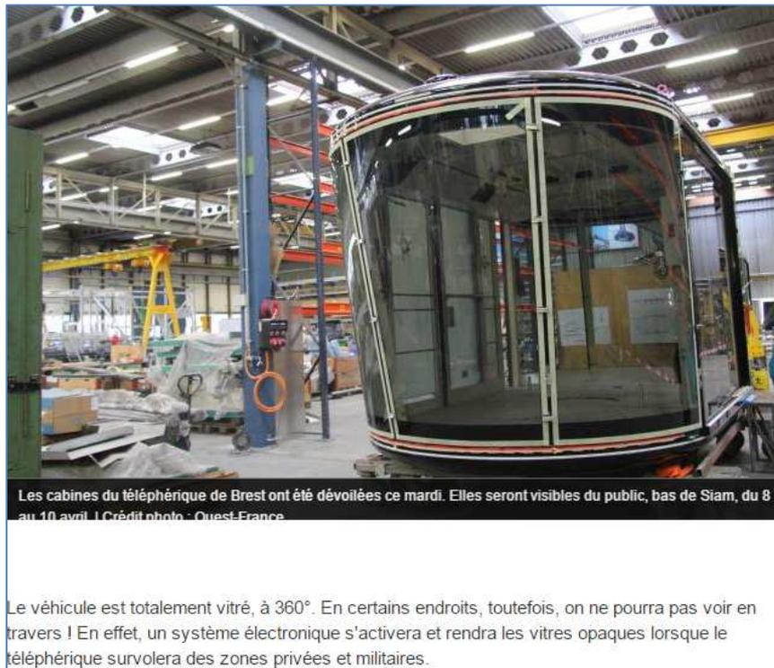
**Figure 4 Exemple de cabine vitrée du métrocâble de Brest pouvant s'opacifier/se teinter automatiquement à l'approche de certaines zones habitées. Source : Ouest-France.fr**
